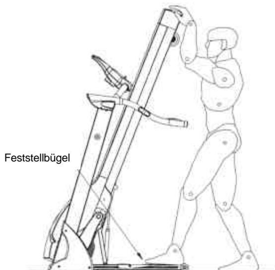
Fassen Sie das Ende der Lauffläche mit beiden Händen an. Drücken Sie die Lauffläche leicht nach oben und treten Sie mit einem Fuß auf den Feststellbügel.
